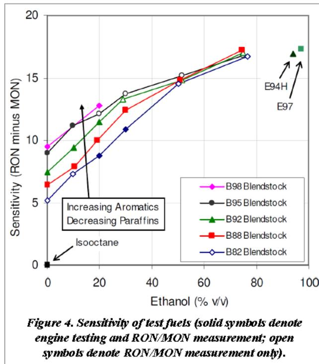
FIGURE 9 FUEL SENSITIVITY VS ETHANOL PERCENTAGE (FROM STEIN, 2012)
